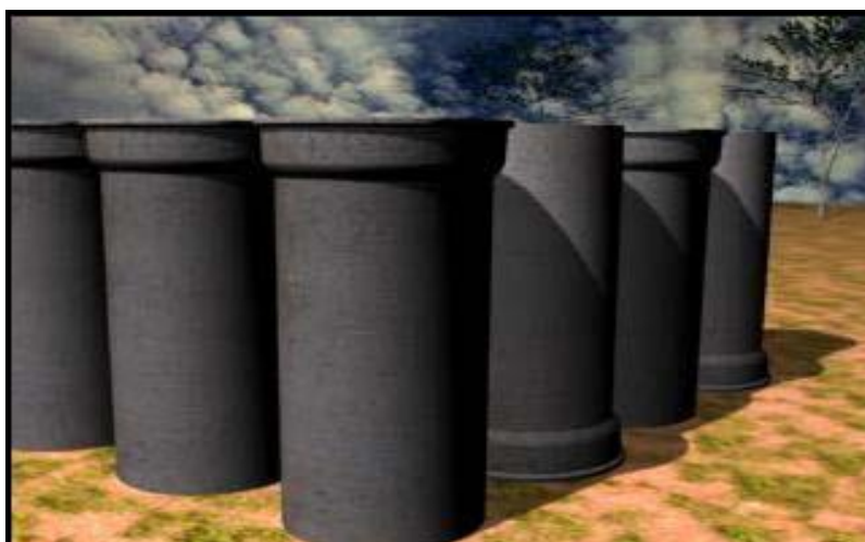
Figura 12 – Tubos estocados na posição vertical
